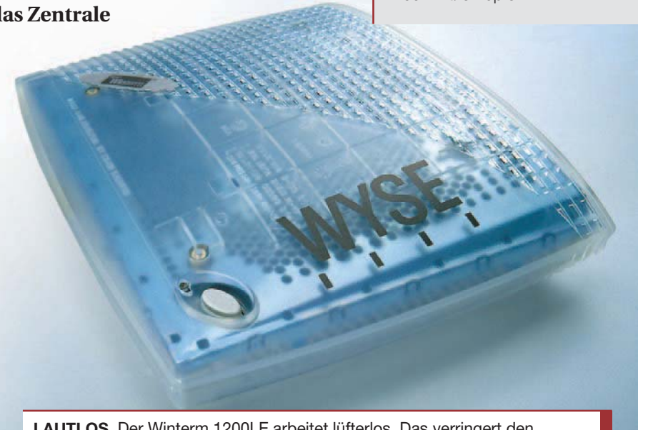
LAUTLOS. Der Winterm 1200LE arbeitet lüfterlos. Das verringert den Geräuschpegel und spart Energiekosten
